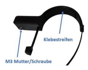
Entfernen Sie vorsichtig die Schutzfolie auf der Rückseite des Klebestreifens und kleben Sie diesen auf die Innenseite der Befestigungsschelle. Stecken Sie die selbstsichernde Mutter M3 komplett in die vorgesehene Aussparung hinein. Anschließend schrauben Sie die M3-Schraube in die Mutter (noch nicht festziehen).
