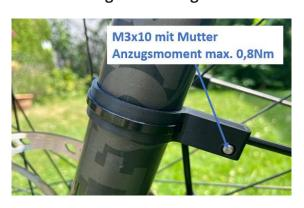
Bringen Sie die Befestigungsschellen an das Federgabelrohr links/rechts mit dem Schlitz nach unten an, sodass diese noch leicht verschiebbar sind (ziehen Sie die Kabelbinder nur leicht an) und stecken Sie die Streben ein (nicht im Lieferumfang). Anschließend schrauben Sie die Schraubverbindung nach Vorgabe (0,8Nm) an. Ziehen Sie nun beide Kabelbinder fest und kürzen Sie diese entsprechend.
