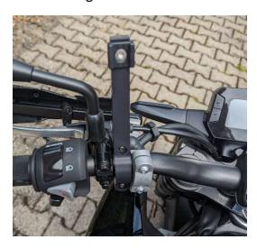
Stecken Sie die selbstsichernden Mutter M4 und M5 komplett in die vorgesehenen Aussparungen hinein.
