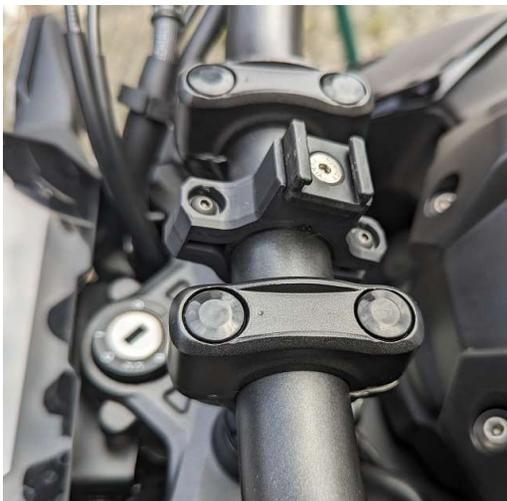
Stecken Sie die selbstsichernden Mutter M4 und M5 komplett in die vorgesehenen Aussparungen hinein.
