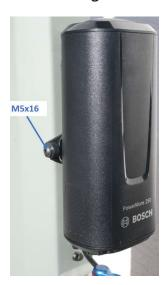
Schieben Sie den Akku in die Originalhalterung bis dieser einrastet.
