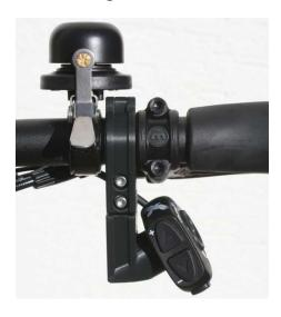
Sie können verschiedene Fahrradzubehörteile befestigen, die für einen Ø22,2mm geeignet sind (Darstellung Rohloff E14 Taster). Bitte beachten Sie die Hinweise des Zubehör-Herstellers.
